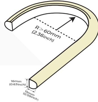
注: 幻彩的弯折半径为  $R \geq 80\text{mm}$  (2.6inch)
